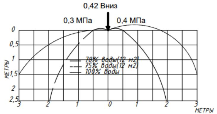
**Графики зависимости интенсивности орошения от давления для оросителей водяных и пенных при
